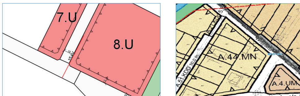
Rysunek 38. Przykładowe fragmenty mapy zwracanej przez usługę KIMPZP, z lewej fragment planu opublikowanego w postaci wektorowej, a z prawej planu opublikowanego w postaci rastrowej
