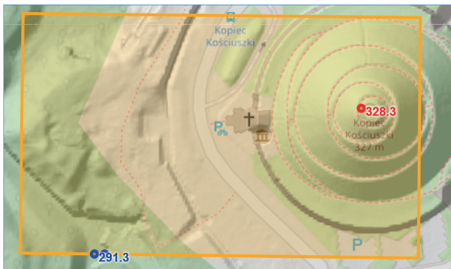
Rysunek 56. Wizualizacja wyników zapytania dotyczącego wyznaczenia minimalnej i maksymalnej wysokości w obszarze
