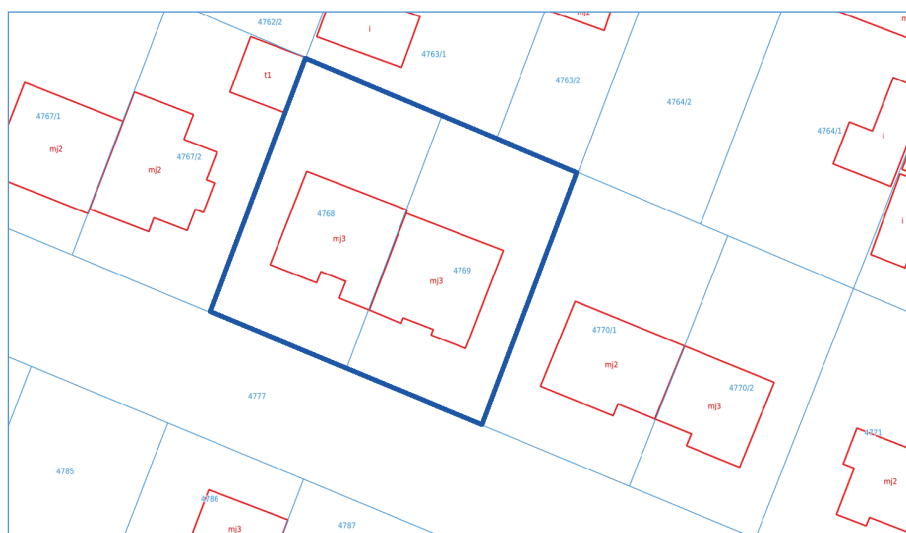
Rysunek 32. Ilustracja agregowania obiektów do jednej geometrii
